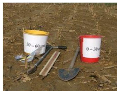
Slika 1. Pribor za vađenje uzoraka tla : sonda, svrdlo, štihlja (ašov), posude
